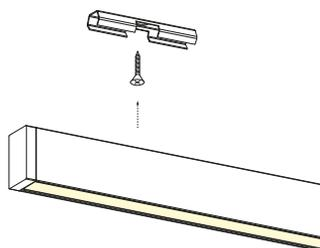
Clip in acciaio per il fissaggio a scatto su superfici piane. La clip si aggancia sulle asole posteriori che risulterà perfettamente aderente alla superficie. Vite M2,5x12 inclusa.
